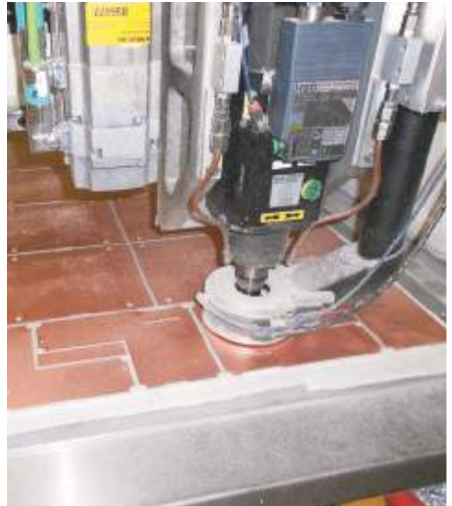
Circuits imprimés usinés sur place.
