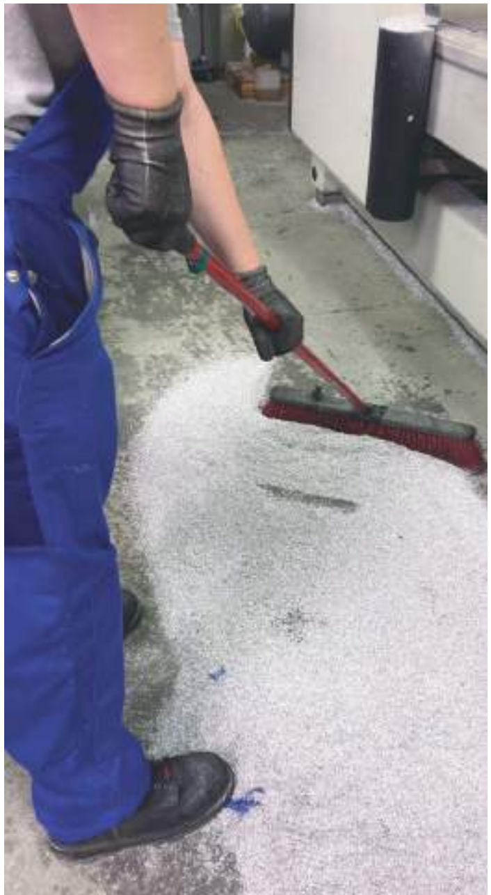
Les copeaux d'aluminium issus du processus d'usinage sont collectés et recyclés.
